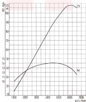
Kennlinien, nach DIN, für Motor Typ 132 AC.9C.6 (1600) mit 5-Gang-Getriebe.
