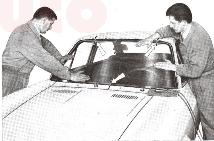
Abb. 121. - Einbau der Scheibe und Druck auf dieselbe zur gleichmässigen Quetschung der Dichtmasse.
